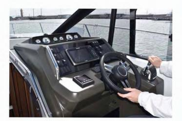
Dockmate bežični daljinski upravljač omogućuje skiperu da upravlja svim funkcijama manevriranja plovila, te da sigurno odradi pristajanje. Zbog dobre veze s plovilom Dockmate daljinskim upravljačem se može upravljati i na udaljenim pozicijama od mosta, pa čak i s obale. Na daljinskom upravljaču se nalaze tipke i joystici koji se povezivanjem s Volvo Pentinom "Drive-By-Wire" tehnologijom povezuju s komandama na plovilu a uključuju i klasične pogone i IPS.
